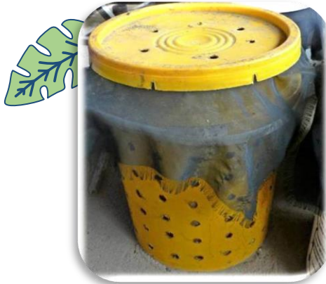
Gambar 1. 14 ember cat yang sudah dilubangi Sumber: sda.pu.go.id
